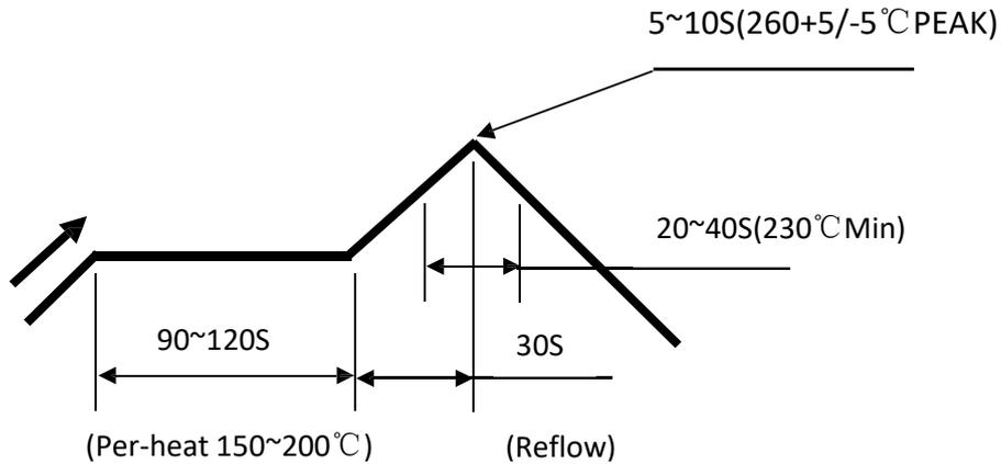
TEMPERATURE CONDITION GRAPH/ (TEMPERATURE ON BOARD PATTERNSIDE)
